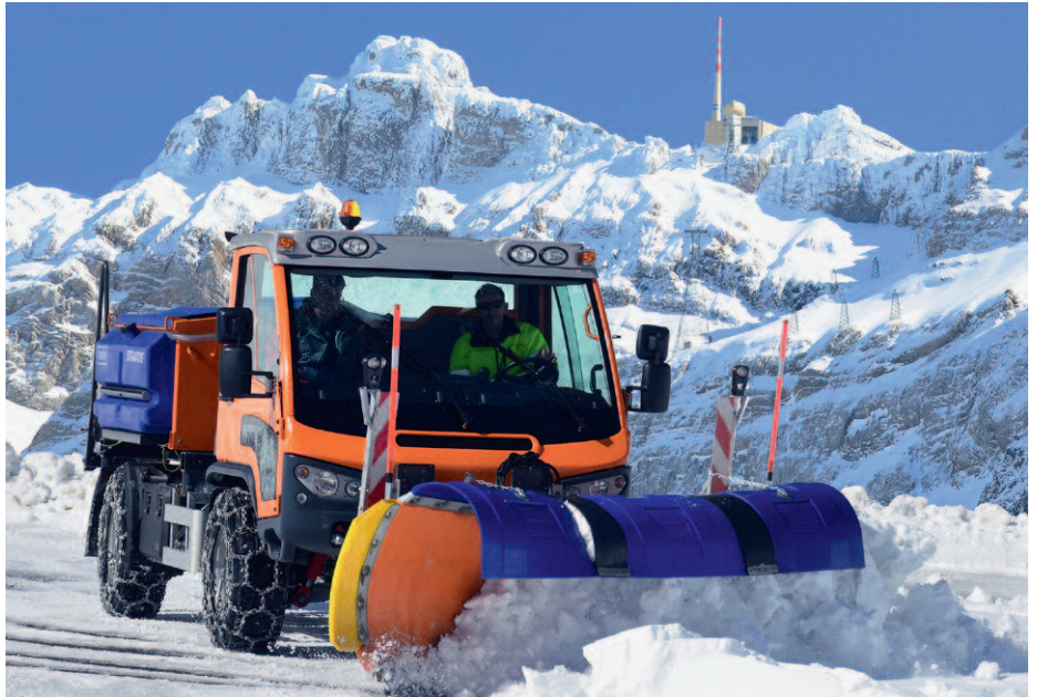
Der Vierjahreszeitentransporter Aebi VT 450 Vario mit stufenlosem Fahrtrieb aus Burgdorf. Bilder: zvg
